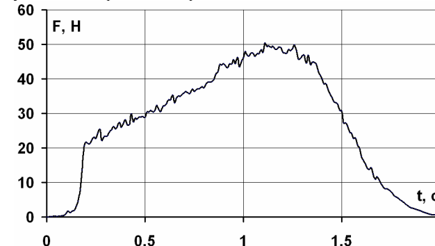
Рис 2 - График изменения тяги двигателя РД1-50-5
